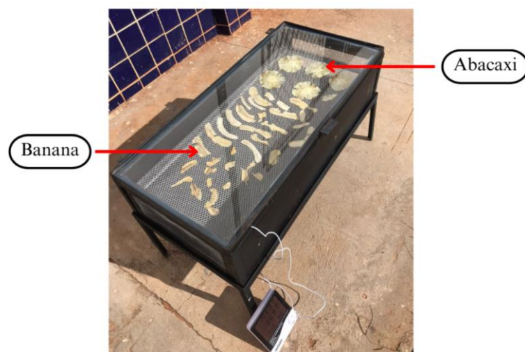
FIGURA 5: Realização do experimento 3: disposição das frutas no secador. (Autoria própria).
