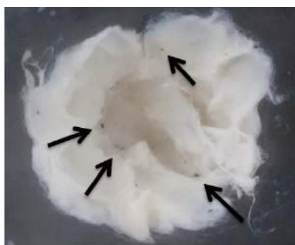
FIGURA 6. Fotografia do algodão após o processo de filtração do óleo de emulsão. As setas indicam as partículas sólidas, provenientes da operação de usinagem, retidas durante o processo.
