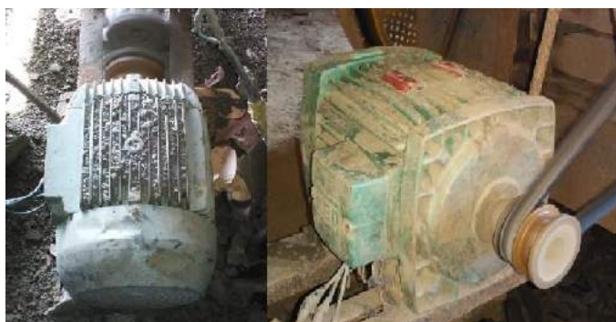
FIGURA 5. Motores elétricos da linha de produção cobertos de poeiras e partículas granuladas de argila.
