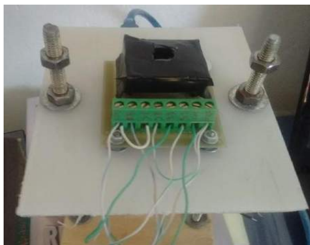
FIGURA 3. Dispositivo desenvolvido para isolar o sensor da luz ambiente (Autoria própria, 2019).
