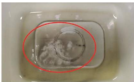
FIGURA 4. Fotografia do recipiente utilizado no processo de filtração, contendo deposição das partículas metálicas ao fundo como resultado do processo de decantação.
