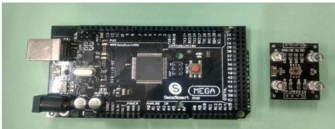
FIGURA 2. Componentes utilizados. A direita, Arduino Mega e a esquerda, o sensor TCS230 (Autoria própria, 2019).
