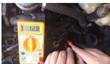
FIGURA 17. Teste do Injetor (Autoria Própria, 2018).
