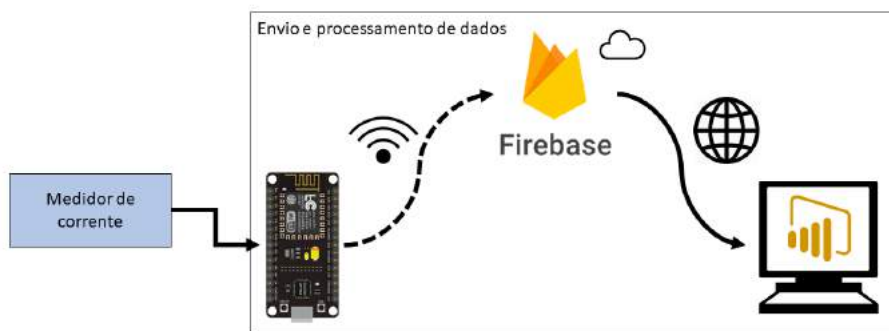
FIGURA 5. Esquema resumido do processo de envio e processamento de dados. (Autoria própria)
