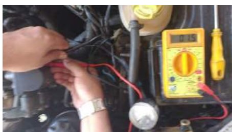
FIGURA 18.1. Teste do Primário (Autoria Própria, 2018)
