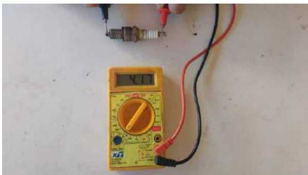
FIGURA 19. Teste da Vela (Autoria Própria, 2018).
