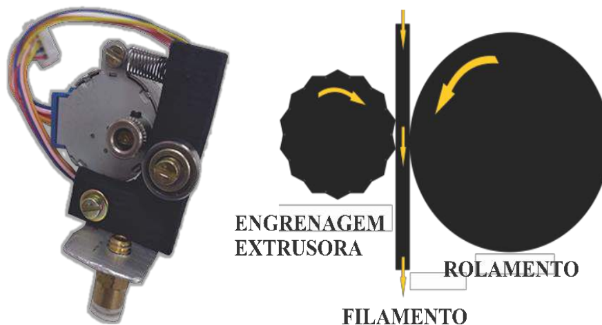
FIGURA 4. Extrusora e esquema de funcionamento. (Autoria Própria)
