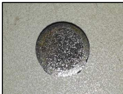
FIGURA 18. Amostra 3 (1100°C) macroscopia após o ataque corrosivo, 2X. (Autoria própria)
