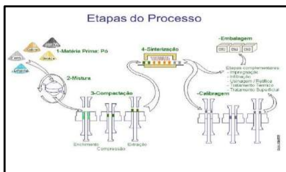
FIGURA 6. Etapas do processo de metalurgia do pó (Generalizado). [11]
