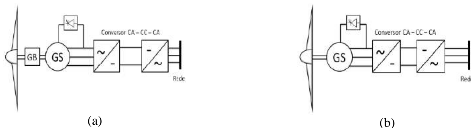
FIGURA 2. Arquitetura das turbinas eólicas tipo IV. (a) Máquina síncrona conectada via conversor de frequência e caixa de engrenagens (tipo IV) [1]; (b) máquina síncrona conectada via conversor de frequência (tipo IV) [1].
