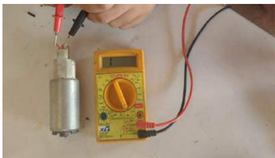
FIGURA 20. Teste da Bomba de Combustível (Autoria Própria, 2018).
