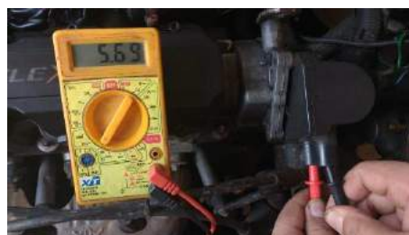
FIGURA 18.2. Teste do Secundário (Autoria Própria, 2018)
