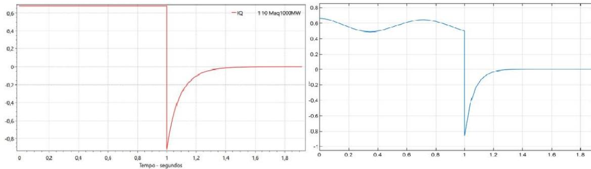
FIGURA 7. Corrente de eixo de quadratura. (Autoria própria)
