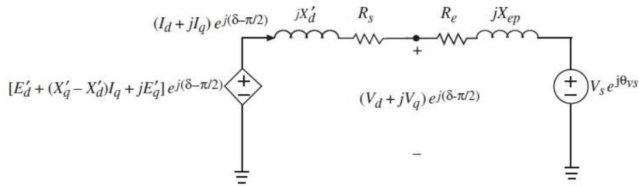
FIGURA 4. Modelo de máquina síncrona de dois eixos. [7]
