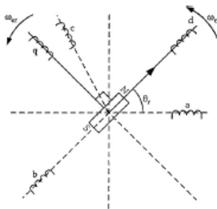
FIGURA 2. Transformação do sistema trifásico no sistema d-q [5].
