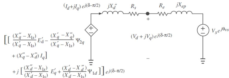
FIGURA 3. Circuito dinâmico sub-trânsitório da máquina síncrona. [7]
