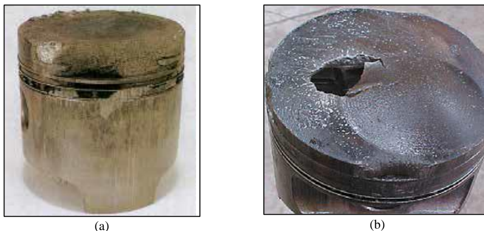
FIGURA 4. Fenômenos devido ao adiantamento ou atraso do ponto de ignição (MAHLE, 2019) (p. 87-88)
