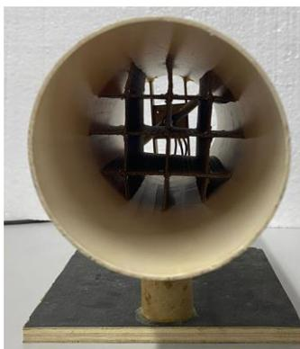
FIGURA 15. Túnel de vento.
