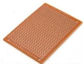
FIGURA 9. Placa de fenolite perfurada [14].
