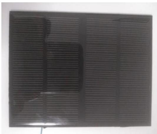
FIGURA 8. Módulo fotovoltaico (autoria própria).
