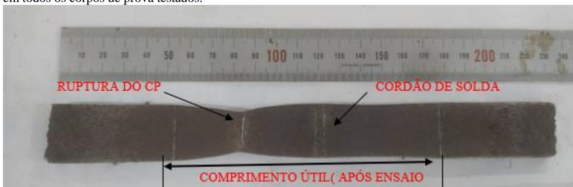
Figura 8. Corpos de prova após ensaio. (Autoria Própria)
