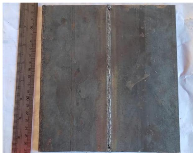
Figura 6. Inspeção visual do cordão de solda (Autoria Própria)
