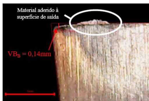
FIGURA 5. Desgaste de flanco médio observado na Ferramenta 2 após a APC ser arrancada no decorrer do processo de usinagem.
