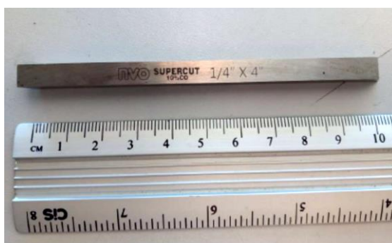
FIGURA 1. Fotografia de exemplar das ferramentas de aço rápido para testes de torneamento.
