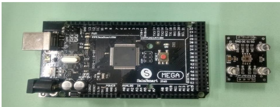
FIGURA 2. Componentes utilizados. A direita, Arduino Mega e a esquerda, o sensor TCS3200 (Autoria própria, 2019).
