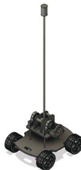
Figura 4. Montagem das partes do pêndulo invertido.
