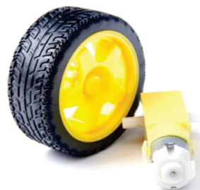
Figura 7. Conjunto motor de corrente contínua e roda.
