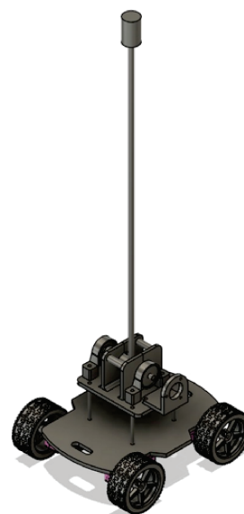
Figura 4. Montagem das partes do pêndulo invertido.
