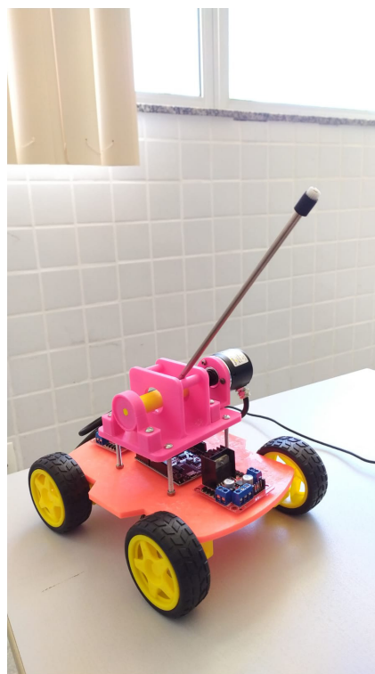
Figura 11. Protótipo de pêndulo invertido desenvolvido.
