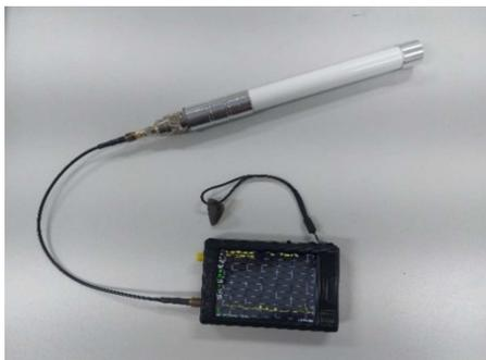
Fig. 7 – Analisador de espectro e Antena.
