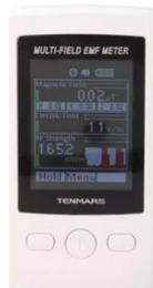
Fig. 3. Medidor de campo eletromagnético TM-190 TENMARS. Fonte: Site TenMars
