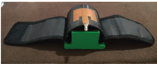
Fig.5. Aplicação da antena com curvatura de 20° em um dispositivo de monitoramento de quedas.
