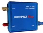
Fig. 5. Equipamento de medição miniVNA tiny [autoria própria].
