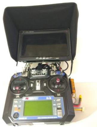
**Figura 1. Transmissor utilizado na interface VANT – PILOTO.**
