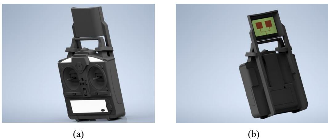
**Figura 09. Modelagem tridimensional de um transmissor (a) visão frontal (b) visão traseira com posicionamento da antena de microfita.**
