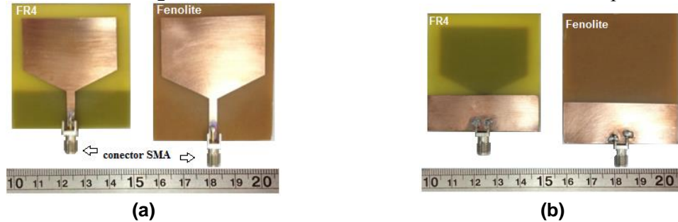
Figura 6. Antenas confeccionadas (a) vista superior (b) vista posterior
