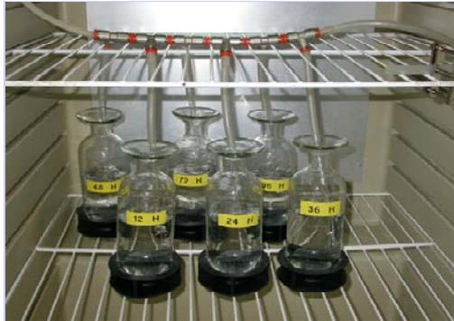
Figura 1. Apresentação dos tratamentos submetidos ao condicionamento osmótico (PEG 6000) dentro de um germinador tipo BOD.
