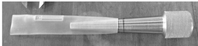
Figura 3. Ferramenta cônica utilizadas na determinação do diâmetro interno do tubo emissor.
