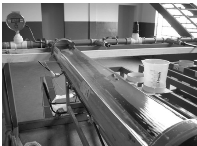
Figura 4. Recipiente plástico com resistência elétrica para aquecimento do tubo emissor.
