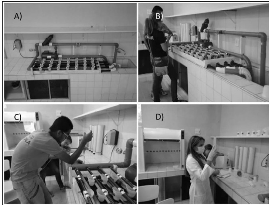
Figura 1. Bancada de avaliação de uniformidade (A), por tempo predeterminado (B), coleta das amostras (C) e medição do volume coletado (D).
