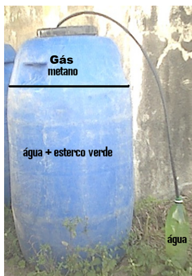
Figura 2. Sistema de preparação do biofertilizante comum e supermagro sob fermentação anaeróbica
