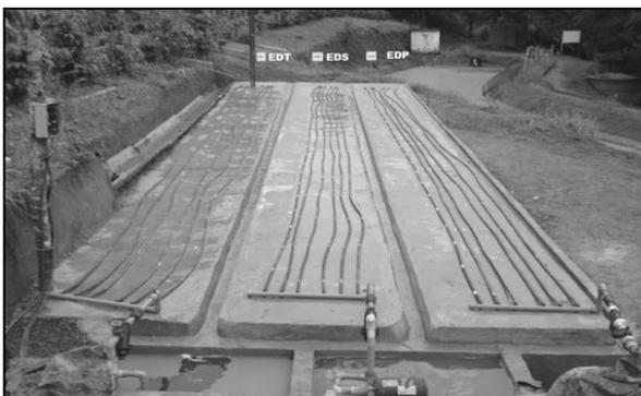
**Figura 2.** Módulos experimentais destacando-se os reservatórios com esgoto doméstico preliminar (EDP), esgoto doméstico secundário (EDS) e esgoto doméstico terciário (EDT), conjuntos de bombeamento, filtros de discos e válvulas reguladoras de pressão.
