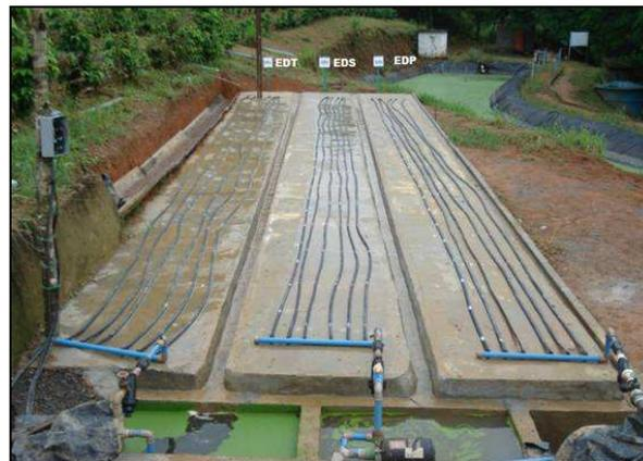
**Figura 2.** Bancadas experimentais dotadas de reservatórios com esgoto doméstico preliminar (EDP), esgoto doméstico secundário (EDS) e esgoto doméstico terciário (EDT), conjuntos motobomba, filtros de discos e válvulas reguladoras de pressão.
