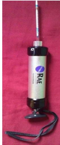
**Figura 1** - Bomba de Amostragem de Gás com tubo colorimétrico acoplado.
